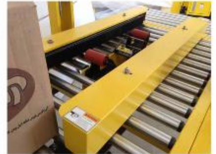
استفاده از غلطک های ضد سایش و طول عمر بالای قطعات
